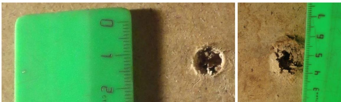
*Рисунок 3 – Фото входного и выходного пулевых отверстий*
