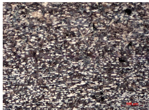
Рисунок 2 – Образец № 4 на границе ЗТВ и материала основы, не подвергшегося структурным изменениям
