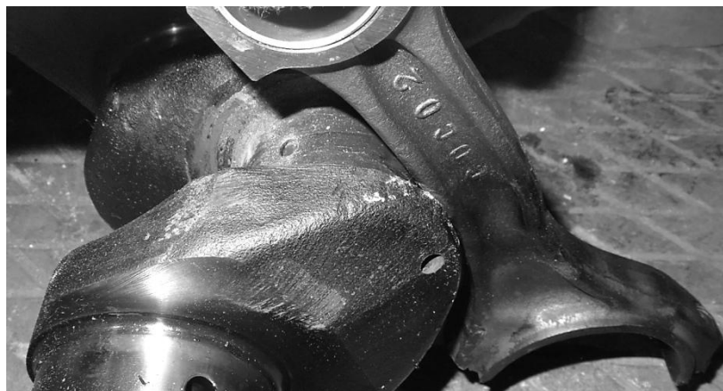
Рисунок 1 – Имитация расположения стержня шатуна при ударе о шатунную шейку
