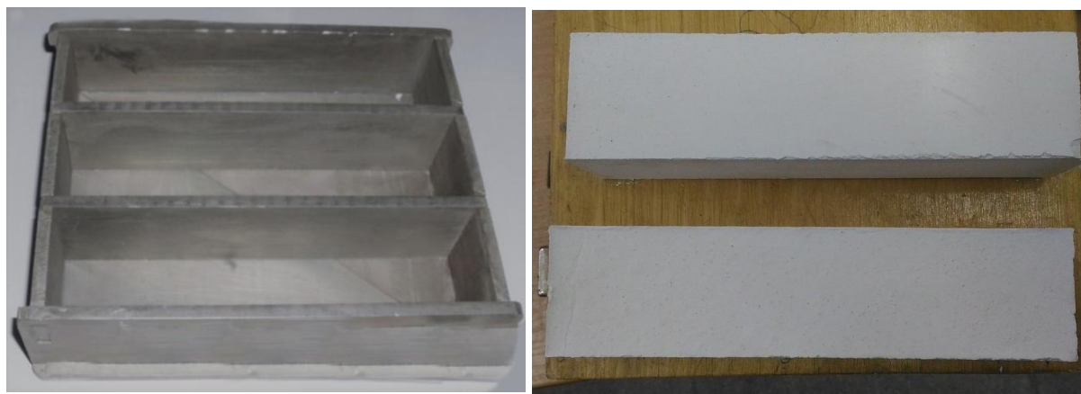
Рисунок 1 – Форма для изготовления образцов-балочек и получаемые образцы
