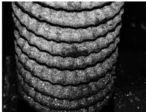
Рисунок 6 – Фильтр грубой очистки смазочного материала, покрытый металлической стружкой.
